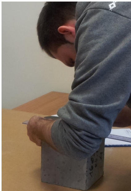
Rys.1. Badanie kostki betonowej
