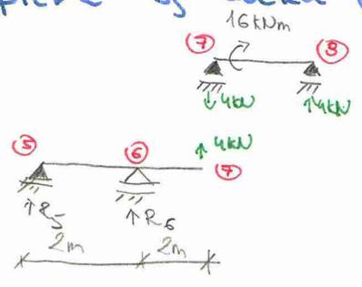
Odciążenie z belki ⑦-⑧ działające w dół przekazuje się na belki ⑤-⑥ skierowane w górę, jest odpowiednią układową na tą reakcję. W ten sposób otrzymujemy równowagę sił w węzle ⑦
