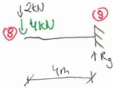
$$M_9 = -(2 \text{ kN} + 4 \text{ kN}) \cdot 4 \text{ m} = -24 \text{ kNm} - \text{moment utwierdzenia wspornika.}$$
