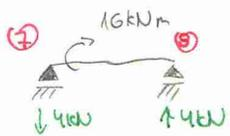
$$R_9 = \sum R = 2 \text{ kN} + 4 \text{ kN} = 6 \text{ kN} - \text{z sumy sił działających pionowo}$$
