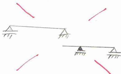
Przegub jest tylko "myślową podporą" więc nie może stanowić oparcia belki bezpośrednio na podłożu.
