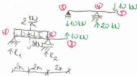
$$\sum M_1 = 0 \Rightarrow (2 \frac{\text{kN}}{\text{m}} \cdot 4 \text{ m}) \cdot 2 \text{ m} - R_2 \cdot 4 \text{ m} - 10 \text{ kN} \cdot 6 \text{ m} = 0$$
