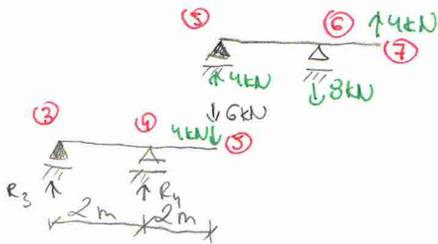
$$\sum M_3 = 0 \Rightarrow (4 \text{ kN} + 6 \text{ kN}) \cdot 4 \text{ m} - R_4 \cdot 2 \text{ m} = 0$$
